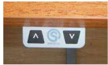
удобно для всех, включая людей с инвалидностью. Высота столешницы регулируется за счет встроенного электропривода нажатием кнопок “вверх” или “вниз” с большим диапазоном высот, что позволяет комфортно пользоваться столом посетителям на инвалидной коляске, людям с различными формами ограничений по здоровью, например, тем, кому тяжело или противопоказано садиться.
