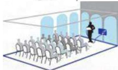
**Стационарная** информационная система с усилителем предназначена для оснащения помещений (зон в помещениях) площадью от 30 до 700 м<sup>2</sup>, монтируется особым образом в пол либо потолок
